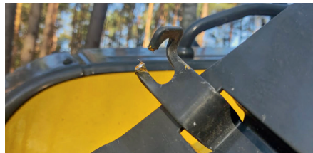
Die Verriegelung wurde mit einer Säge oder Flex zerstört
