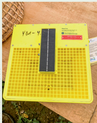
Digitale Gelbschale zur Schadschwelenermittlung im Raps.
