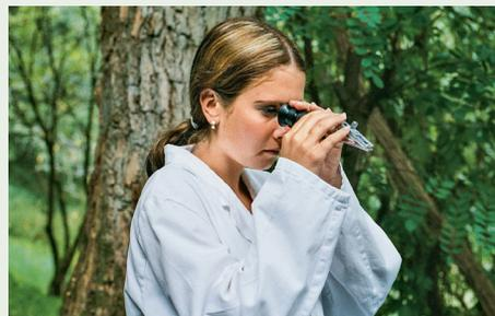
Refraktometer zur Bestimmung des Wassergehalts.
