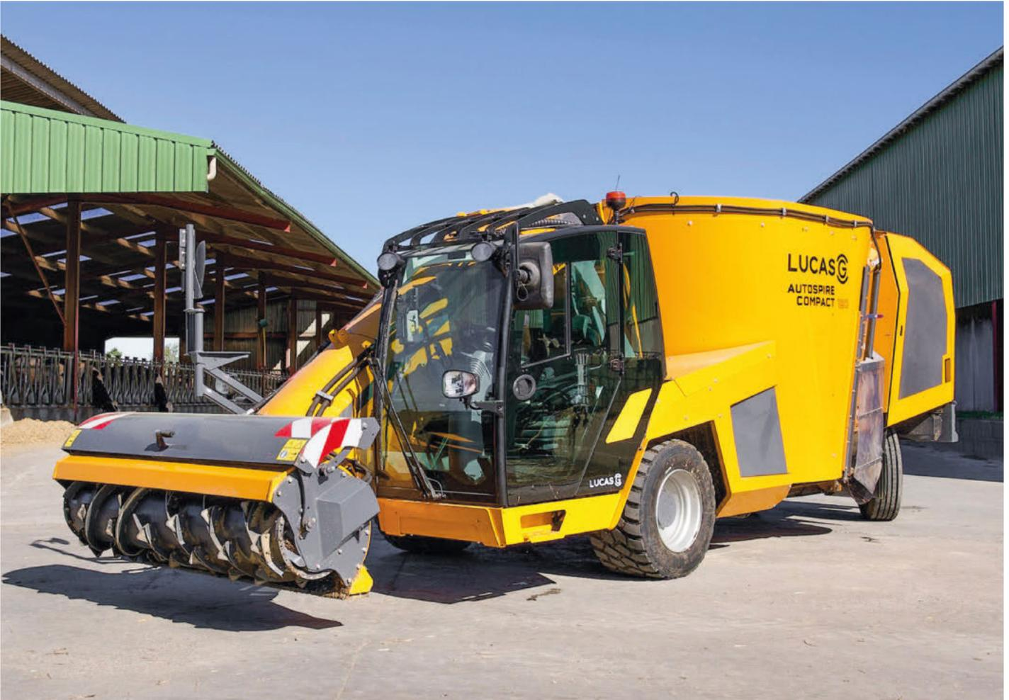
**Autospire compact – selbstfahrender Schneckenmischer für klein strukturierte Betriebe**
