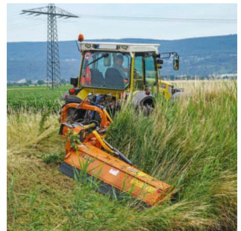
Der Berti Universalmulcher TA/PS ist für den Heckanbau gebaut. Er kann seitlich verschoben werden.
