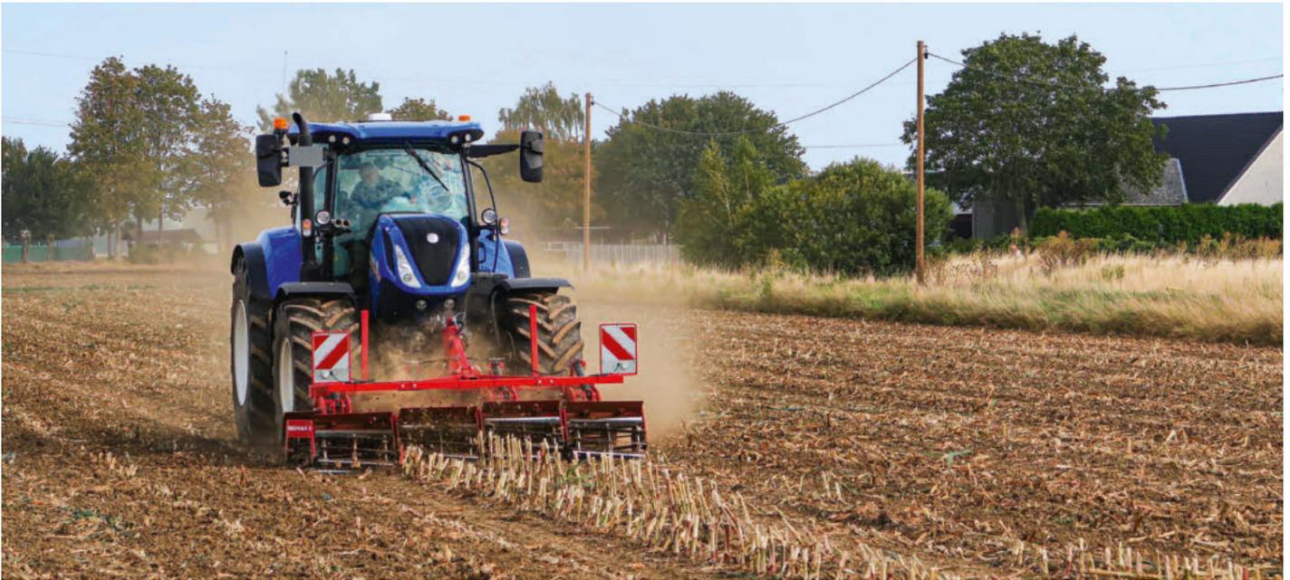
Der Speedmax von Knoche zerkleinert z. B. Maisstoppel oder Zwischenfrüchte durch seine zwei passiven Walzen besonders kraftstoffsparend. Durch 75 cm breite Walzenelemente hat er eine optimale Bodenanpassung.
