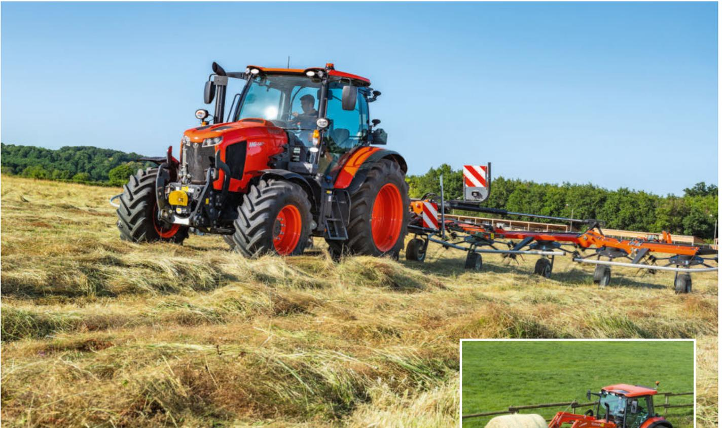
Die Baureihe M6002 (Foto o.) von Kubota überzeugt mit hoher Wendigkeit durch seine Portal-Vorderachse. Mit seinen vier Zapfwellengeschwindigkeiten und dem fein abgestuften Lastschaltgetriebe ist er der ideale Allrounder auf den Höfen.
