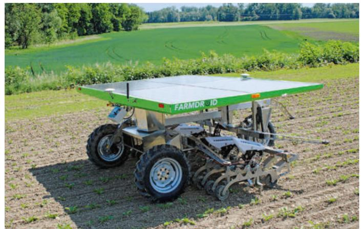
**Farmdroid:** Diesen Sä- und Hack-Roboter hatten zwei dänischen Landwirte gebaut. Die Nachfrage nach diesen kleinen und leichten Fahrzeug mit PV-Dach ist sehr groß.
