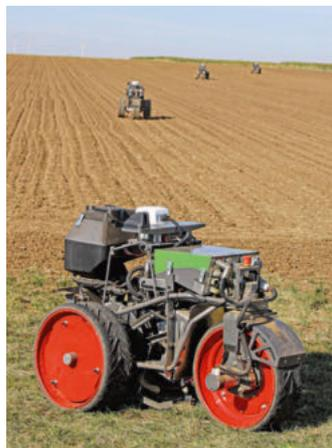
**Diese kleine Miniroboter** (hier von Fendt) sollen im Schwarm autonom säen.
