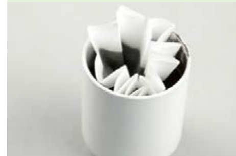
Eintauchen eines Filterpapiers in die Lösung, Abwarten bis Filtrat ansteht
