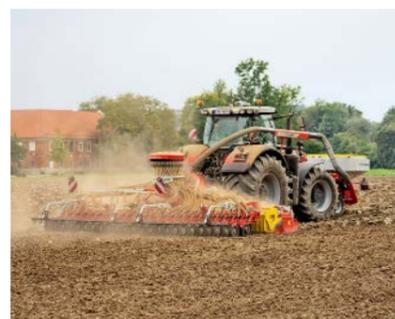
Die klappbare Säsiene punktet mit kurzem Anbau für einen Schwerpunkt nahe am Traktor.
