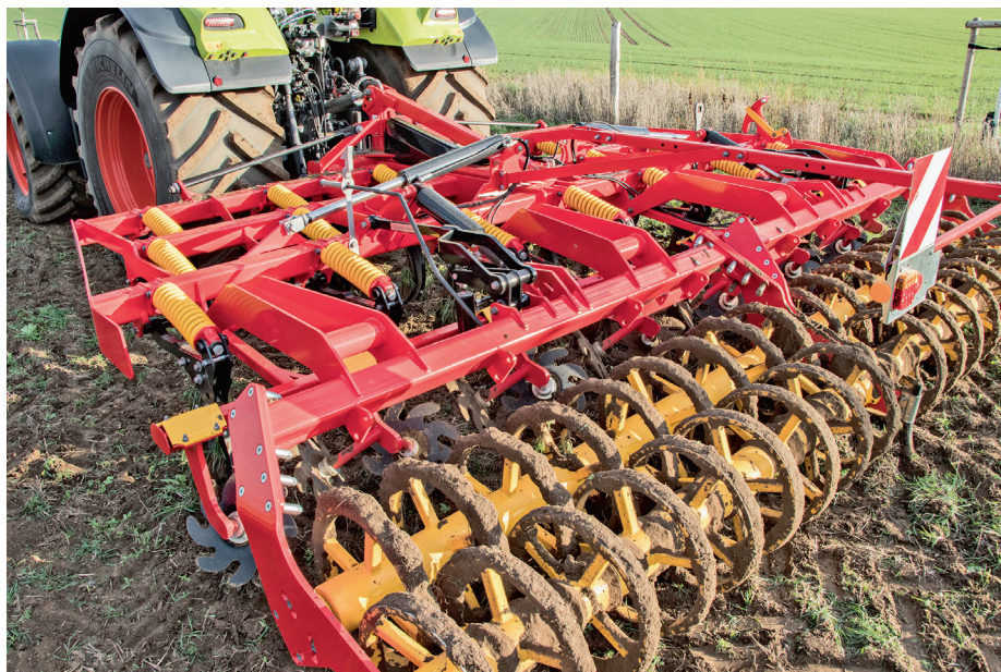
Die U-Profil-Walze als Tandem bringt ordentlich Gewicht mit und fordert das Heckhubwerk heraus.
