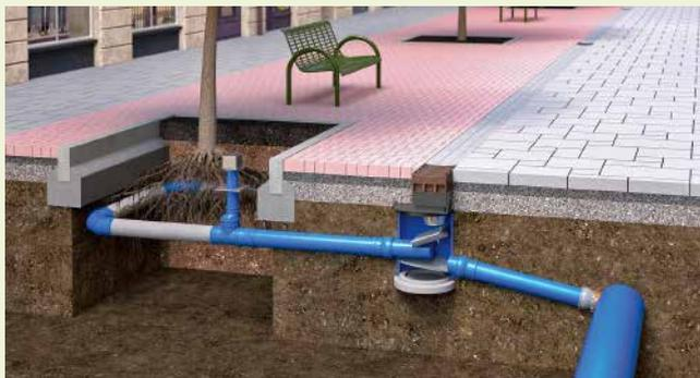
*Der untere Anschluss des BeWa®-Ablaufs ist mit dem Regenwasserkanal verbunden, der obere Anschluss leitet das gesammelte Oberflächenwasser zum Baumstandort.*
