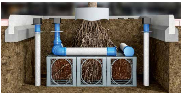
Funke Kunststoffe sorgt für die Reinigung und Ableitung von Oberflächenwasser zum Baumstandort. Grafik: Funke Kunststoffe GmbH
